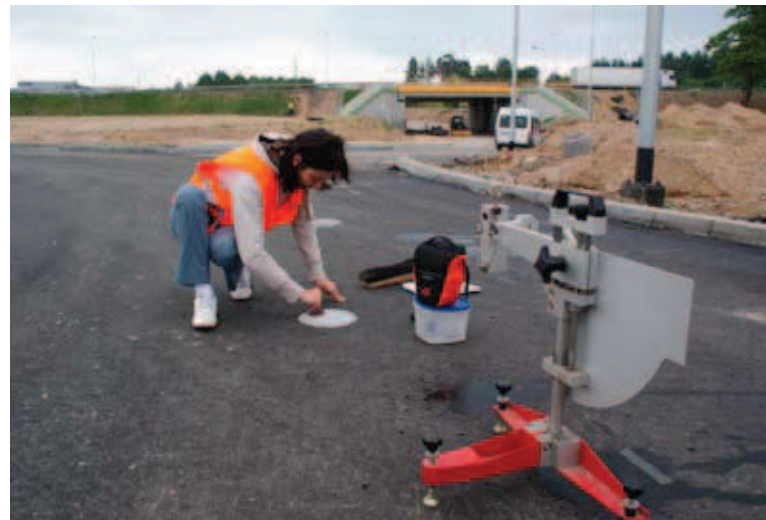
fot. 2. Pomiar makrotekstury nawierzchni drogowej
