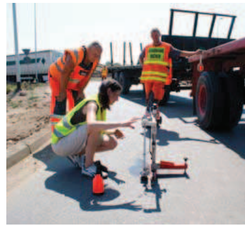
fot. 1. Pomiar właściwości drogowych wahadłem angielskim
